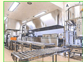
配送時間に合わせて洗米から炊き上げまで自動で行う電気式連続炊飯機。
