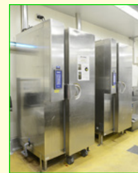
●ブラストチラー 20段カート式をはじめとする、10台以上のブラストチラーによって安全で効率的に冷却しています。
