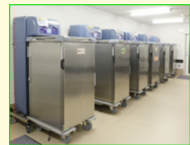
●再加熱カート 焦げつきや加熱ムラのない熱循環式再加熱カートで、温かいものは温かく、冷たいものはしっかりと冷たく召し上がっていただけます。
