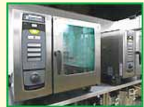
焼き物、蒸し物、炒め物など、幅広いメニューを自動調理するスチームコンベクションオーブン。
