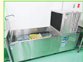
真空包装して一次加熱した食材を1～2℃の冷水で冷却するタンブルチラー。
