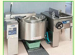
大量の食材を加熱調理できる電気回転釜。
