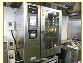
温度と時間と加湿量を設定するだけで調理ができるスチームコンベクションオーブン。
