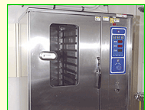
1台で何役もこなす多機能加熱調理機器 スチームコンベクションオープン。
